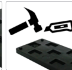
GRIBETAPPER KAN SLÅS NED MED EN HAMMER ELLER SKÆRES VÆK MED EN HOBBYKNIV
